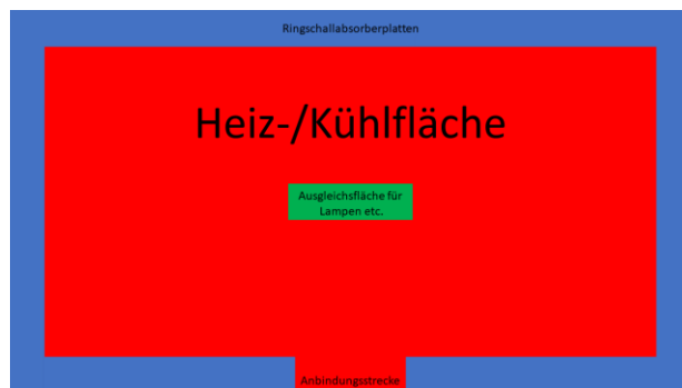
Maximale Heiz-/Kühlleistung mit Ringschall-Absorberplatten
