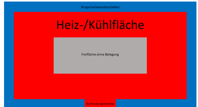
Deckensegel außenliegend mit Ringschall-Absorberplatten
