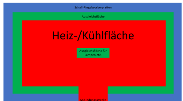
Geringere Heiz-/Kühlleistung mit Ringschall-Absorberplatten
