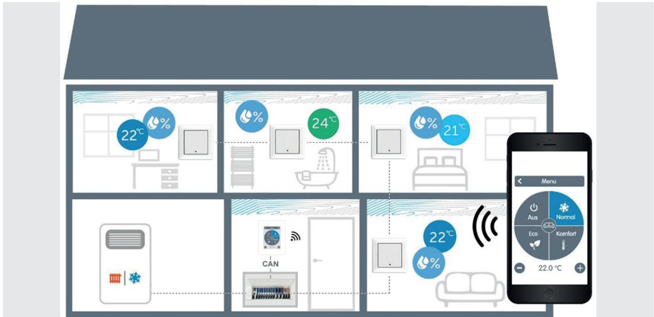
App-basiert mit raumweiser Regelung der Temperatur & Feuchtigkeitsüberwachung. Die Verbindung der Steuereinheiten untereinander erfolgt mit einem geeigneten CAN-Buskabel. Einputzfühler werden nur für den statischen Heiz-/Kühlbetrieb benötigt, d.h. bei festen Systemtemperaturen.
