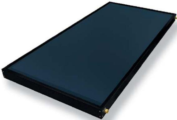
Der Wunder ALS von Solimpeks ist ein leistungsstarker Flachkollektor mit einem lasergeschweißten Absorber aus beschichtetem, hochselektivem Aluminium. Sein harfenförmiger Aufbau gewährleistet eine gleich-mäßige Wärmeverteilung im Kollektor, minimale Druckverluste und eine optimale Entlüftung durch die Steigrohre.
